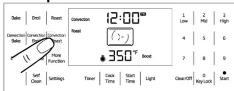
La calefacción superior e inferior están encendidas. El calor viene de arriba y de abajo y es circulado a través del horno por el ventilador de convección. El modo de asado por convección se puede utilizar para carne, aves y grandes cantidades de alimentos asados.
