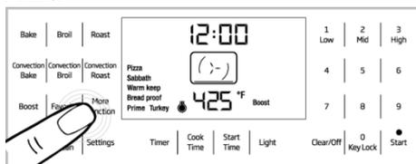
La temperatura inferior está activada. El calor viene del fondo y es circulado a través del horno por el ventilador de convección. El modo de pizza se puede usar para la pizza fresca y congelada. Siga las instrucciones del fabricante para la pizza congelada.
