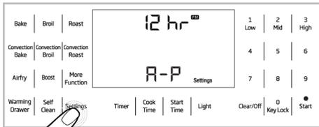
2. "Una vez que "12/24" comience a parpadear en la pantalla, use el panel táctil numérico y presione 1 (durante 12 horas) o 2 (durante 24 horas) escala de tiempo.
