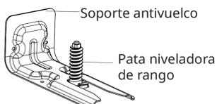
"Después de la instalación, agarre con cuidado la parte trasera de la estufa para asegurarse de que el soporte antivuelco se acople al pie trasero de la estufa".
