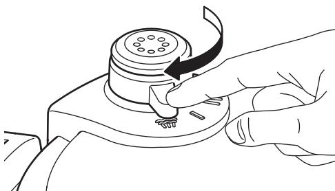
3. Espera hasta que la presión se distribuya uniformemente y la válvula roja de seguridad 4 haya bajado.
