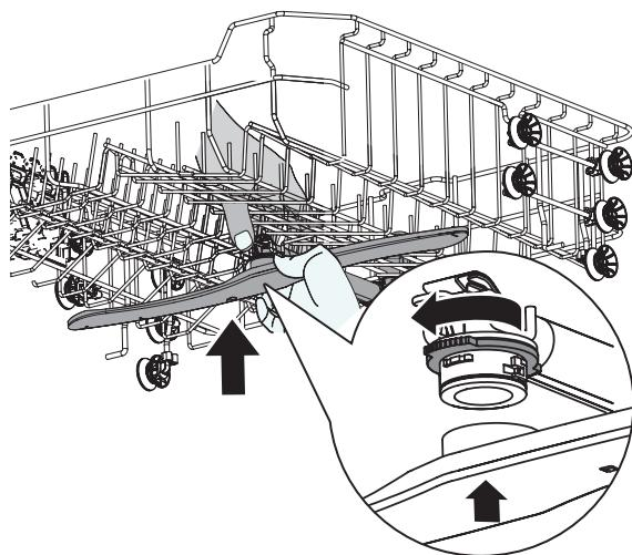
Alt püskürtme kolunu cihazın alt kısmına takmak için alt püskürtme kolunu yerine yerleştirin.
