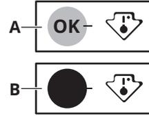
Gıdaları uygun şekilde saklayabilmeniz için buzdolabında bir sıcaklık göstergesi bulunmaktadır. Cihazın yan duvarındaki semboller, buzdolabının içindeki en soğuk alanı gösterir.
