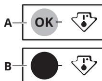
Za pravilno skladištenje hrane hladnjak je opremljen indikatorom temperature. Simbol na bočnoj stijenci uređaja označava najhladnije područje hladnjaka.
