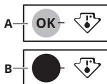
Az élelmiszerek megfelelő tárolása érdekében a hűtőszekrény hőmérséklet-visszajelzővel van felszerelve. A készülék oldalfalán található szimbólum a hűtőszekrény leghidegebb területét jelzi.
