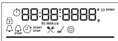
Дисплей със зададени функции на бутоните.
