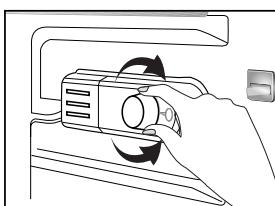
Работната температура се регулира от терморегулатора.
