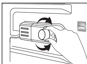
**Radna temperatura određuje se programatorom temperature.**
