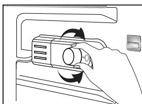
**Radna temperatura određuje se programatorom temperature.**
