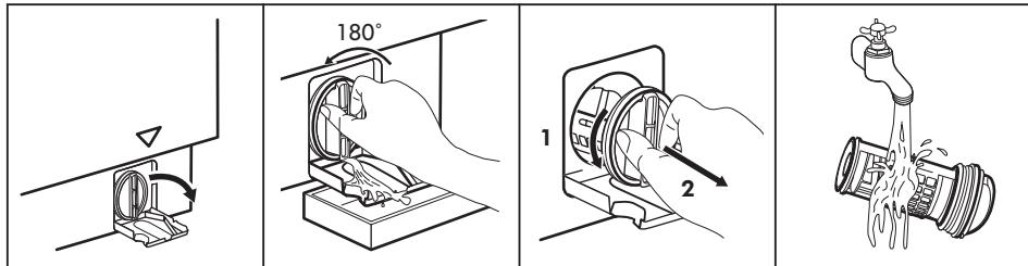
**Nettoyage du tuyau d'arrivée d'eau et du filtre de la vanne**
