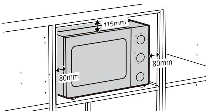
(1) La superficie trasera del aparato se debe colocar contra la pared. Deje un espacio mínimo de 11.5 cm por encima del horno y de 8 cm entre el horno y las paredes contiguas.
