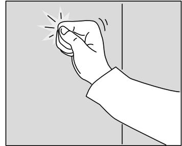
벽이 서스펜션 레일과 수납장을 설치할 수 있을 만큼 튼튼한지 확인하세요. 주방 벽의 재질에 맞게 스테드나 보조빔 위에 레일을 설치하는 게 가장 좋습니다. 이때 전기식 스테드 파인더를 사용하면 편리해요.
