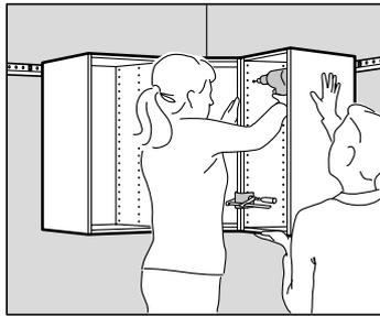
먼저 코너수납장을 설치하고 나사로 고정합니다. 남은 벽수납장을 설치하고 제품 구성에 포함되어 있는 나사로 연결합니다. 나사는 하부수납장까지 모두 설치하고 정렬 상태를 확인한 다음에 조여주세요.
