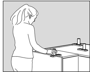
조립설명서에 따라 하부수납장을 모두 조립합니다. 수납장의 설치 순서에 따라 올바르게 다리를 부착해주세요.
