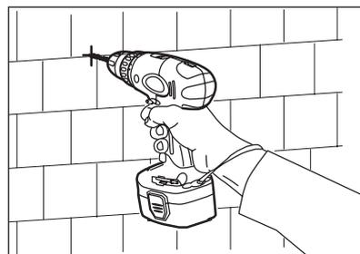
破損しないようダイヤモンドチップドリルビットを使って取付け穴をあけます。ダイヤモンドチップドリルビットがない場合は、タイルにマスキングテープを貼るとドリルがずべりにくくなります。
