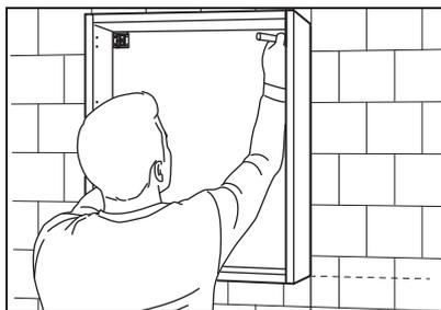
それからウォールキャビネットの位置を、すでに印を付けたウォールキャビネットのボトムラインと、さきほど引いた垂直の線に合わせます。位置を合わせたら、壁の取り付け穴の位置に印を付けます。
