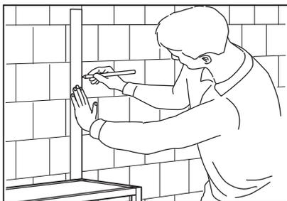
洗面台を取り付けたら、洗面台キャビネットの横から垂直に線を引きます。
