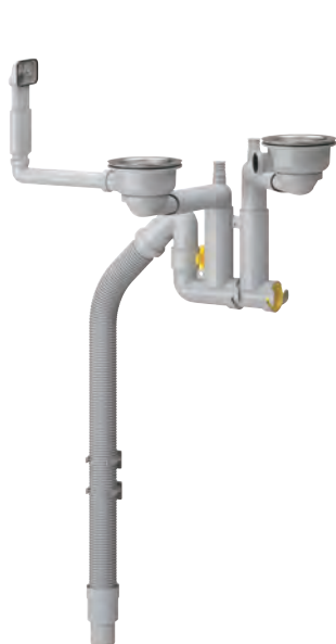
LILLVIKEN/リルヴィーケン 排水トラップ/ストレーナー ダブルボウル用 ステンレススチール製のストレーナー付き シンクストッパーが付属しています。パッキングは合成ゴ ム製、パイプはポリプロピレンプラスチック製。
