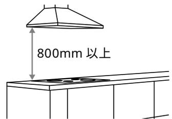
**05** 安全性と機能性を確保するため、コンロの上にレンジフードや換気扇を、組み立て説明書に記載された高さで取り付けます。
