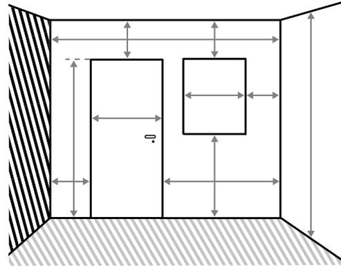
**02** それぞれの窓の寸法と、床、天井、端からの間隔を測ります。ドアについても同じように測ります。ドアや窓を開けるときに必要なスペースも忘れずに書きとめます。
