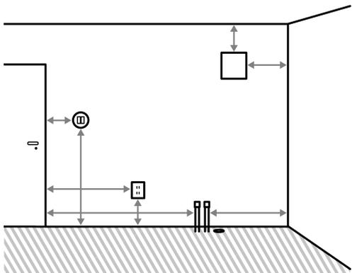
**03** 既存のコンセントや照明のスイッチ、暖房器具や換気口、ガスや水道の配管の場所などをメモします。壁や床から突き出しているものは、どの程度飛び出しているかを測って書きとめます。位置を変更したり新たに設置する場合は、その希望位置を記入します。
