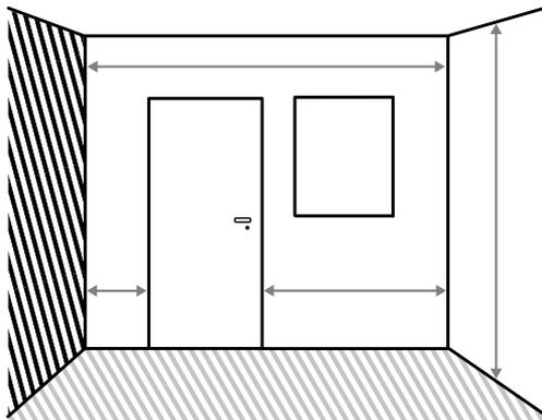
**01** まず床から天井までの長さを測ります。次に壁の横幅と、端からドアまでの間隔を測ります。梁の位置、高さも測ります。
