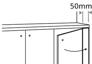
**07** 台やウォールキャビネットと壁との間に 50mm のフィラーを取り付けて、扉や引き出しが完全に開くようにします。
