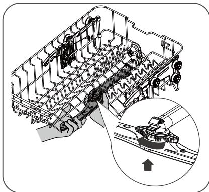
Για να συνδέσετε τον κάτω βραχίονα ψεκασμού στο κάτω μέρος της συσκευής, τοποθετήστε τον κάτω βραχίονα ψεκασμού στη θέση του.
