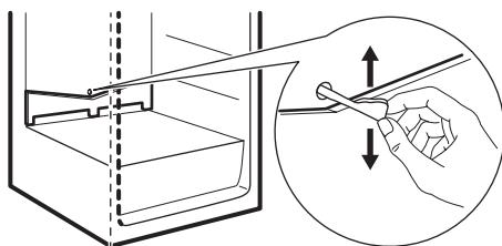
O carazo elimínase automaticamente do evaporador do compartimento frigorífico cada vez que se detén o compresor do motor, durante o uso normal. A auga de desconxelación sae a través dunha canle a
