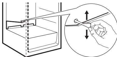
Antzigarra automatikoki kentzen da hozkailuko lurrun-gailutik motorraren konpresorea gelditzen den bakoitzean, erabilera normalean. Desizozteko ura kanal batetik irteten da ontzi berezi batera,
