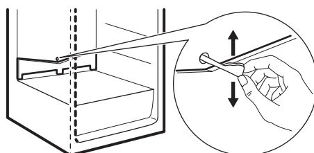
El gel s'elimina automàticament de l'evaporador del compartiment frigorífic cada vegada que s'atura el compressor del motor, durant l'ús normal. L'aigua de descongelació surt a través d'un canal a un recipient
