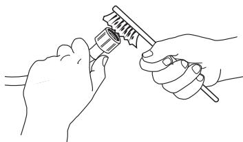
3. Skru nu indløbsslangen af bag på vaskemaskinen med hånden. Træk trådfilteret ud fra ventilen bag på vaskemaskinen med en tang, ogrens det grundigt.
