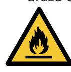
Trubky chladicího okruhu obsahují malé množství ekologického, ale hořlavého chladiva R600a. Nepoškozuje ozónovou vrstvu a nezvyšuje skleníkový efekt. Při úniku chladiva může dojít k poranění očí nebo ke vznícení. Nepoškozujte trubky.
