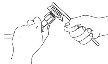
3. Kézzel csavarja le a vízbevezető csövet a mosógép hátljáról. Húzza ki a hálós szűrőt a mosógép hátoldali szelepéből egy fogóval, és óvatosan tisztítsa meg.
