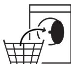
Deschideți hubloul și încărcați rufe. Încărcați rufe una după alta, lăsând spațiu în tambur, fără a-l supraîncărca. Respectați valorile de încărcare indicate în „TABELUL CU PROGRAME”. Supraîncărcarea mașinii va duce la rezultate de spălare nesatisfăcătoare și rufe șișonate.
