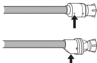
Vízzáró tömlök esetén: ellenőrizze a kis biztonsági szelepet a vizsgálóablakban (lásd a nyílat). Ha piros, akkor a vízzáró funkció aktiválódott, és a tömlőt újra kell cserélni.
