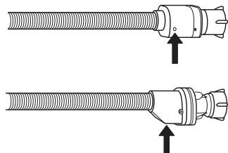
Hadice s automatickým systémem zastavování přívodu vody: zkонтrolujte malé inspekční okénko na bezpečnostním ventilu (viz šipka). Je-li červené, byla aktivována funkce bezpečnostního uzavření a hadici je třeba vyměnit za novou.
