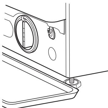
3. Evacuați apa: rotați încet filtrul în sens antiorar până când s-a scurs toată apa. Lăsați apa să curgă, fără a scoate filtrul. Odată ce recipientul este plin, închideți filtrul de apă rotindu-l în sens orar. Goliți recipientul. Repetați procedura până când este evacuate întreaga cantitate de apă.
