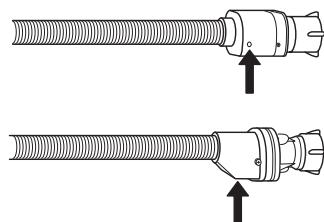
Pentru furtunuri cu oprire a alimentării cu apă: inspectați vizorul mic al supapei de siguranță (vedeți săgeata). Dacă se vede culoarea roșie, a fost declanșată funcția de oprire a alimentării cu apă, iar furtunul trebuie înlocuit cu unul nou.
