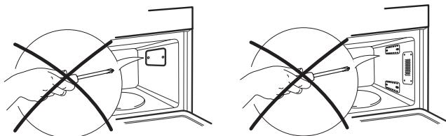
Proverite pre montaže da li je unutrašnjost pećnice prazna.
