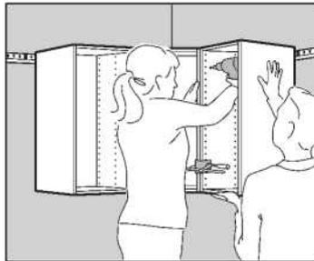
Posiciona el mueble esquinero primero y fíjalo apretando los tornillos. Pon el resto de los muebles y únelos con los tornillos incluidos. Espera a apretar los tornillos hasta que los muebles base estén en su lugar y puedas asegurarte
