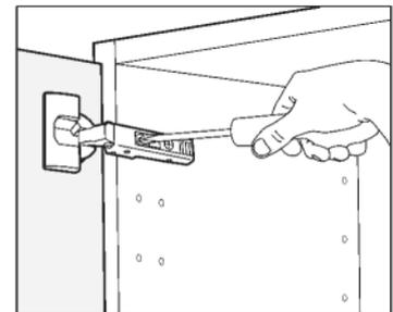
Ajusta los tornillos de la placa de la bisagra para alinear las puertas a la altura y anchura correctas.
