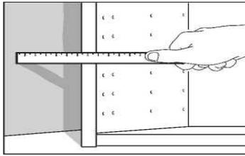
Comprueba que tu pared esté pareja con el nivel. Si la pared está pareja, mide la distancia entre la pared y el mueble y márcala en la parte superior e inferior de la pieza de relleno.
