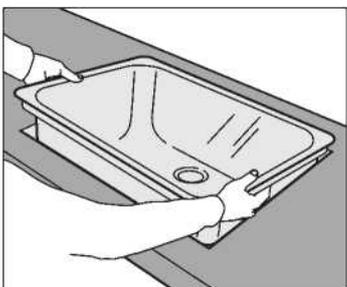
Instala el lavaplatos en la cubierta según las instrucciones de armado.
