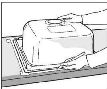
Marca un lugar para el lavaplatos poniendo la cubierta en su lugar. Traza el interior del mueble base en la parte inferior de la cubierta. Esto te ayudará a alinear tu lavaplatos. Da vuelta la cubierta y traza el contorno de tu lavaplatos en cinta para enmascarar.
