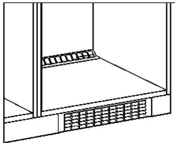
Si vas a instalar una rejilla de ventilación, pon la rejilla entre dos piezas de zócalo.
