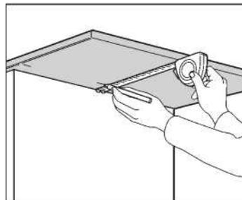
Realiza una medida de prueba a tu cubierta, si tienes una cubierta precortada ahora es el momento de cortarla en el tamaño adecuado. Para evitar que se astille, corta con la parte inferior de la cubierta hacia arriba si usas una sierra circular o una sierra caladora, pero con la parte superior si usas un serrucho.
