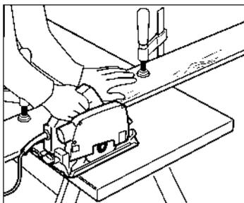
Usa una sierra circular (disco para madera) y prensas C para sujetar la cubierta y lograr un borde recto para cortar y así personalizar su tamaño. Es útil usar un par de caballetes para ayudarte. Un tip es hacer que otra persona sostenga la pieza para cortarla y de esta manera evitar que el borde se astille.
