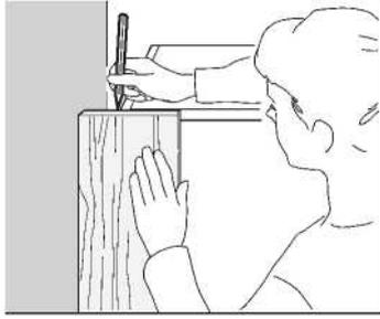
Pon el borde recién cortado de la pieza de relleno contra la pared (debe encajar perfectamente). Marca el borde del mueble en la parte superior e inferior de la pieza de relleno. Dibuja una línea recta desde estos puntos y corta.
