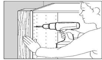
Para asegurar que la pieza de relleno no se mueva, primero fija una tira de soporte en la pared. Taladra agujeros en el mueble para los tornillos que usarás para fijarlo con la pieza de relleno. Pon la pieza de relleno en su lugar. Pon los tornillos en los agujeros que perforaste. Una vez que todas las piezas de relleno estén puestas, calafatea alrededor de cada una de ellas con silicona para obtener un sellado hermético.
