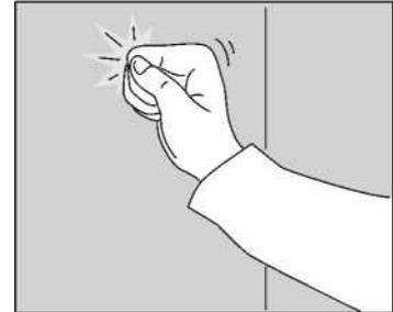
Revisa que la pared sea lo suficientemente sólida como para colgar el riel de suspensión y los muebles. Dependiendo del material de la pared, es mejor instalar el riel en un montante o una viga de apoyo. Un detector de metales electrónico puede ser útil.
