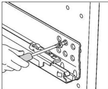
Una vez que tus guías para cajones exteriores estén instaladas, monta las guías para cajones interiores. Las guías para cajones interiores se montan en la fila de agujeros interiores de tu mueble.
