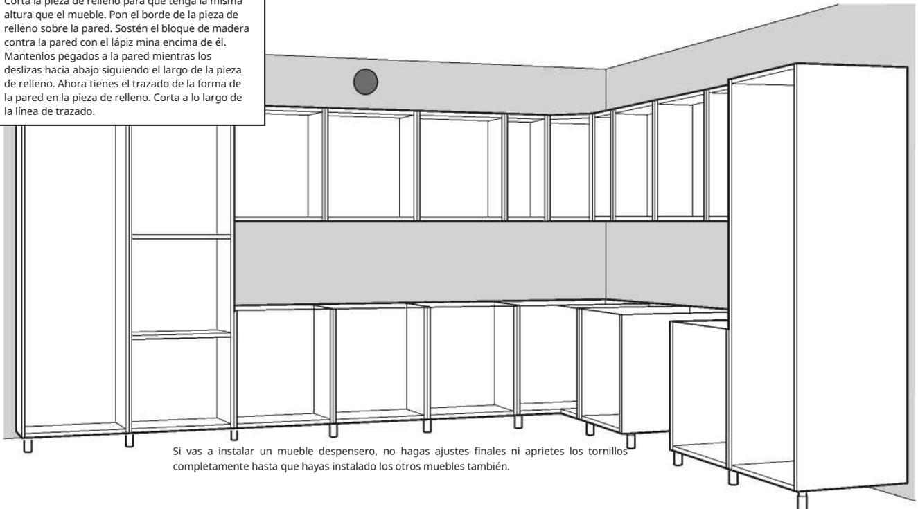
Si vas a instalar un mueble despensero, no hagas ajustes finales ni aprietes los tornillos completamente hasta que hayas instalado los otros muebles también.
