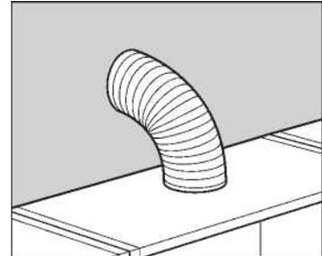
Sierra un agujero en el panel trasero o en la parte superior del mueble. Consulta las instrucciones de armado. Por razones de seguridad y funcionalidad, sigue las medidas exactas en las instrucciones de instalación incluidas en la campana extractora/ventilador.
