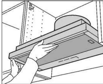
Instala la campana extractora. Las campanas extractoras de IKEA pueden instalarse de dos formas: con conductos hacia el exterior, llamado extracción o en modo de recirculación con un filtro de carbón. Cada opción de instalación se describe en las instrucciones de armado incluidas con el producto. Toma en cuenta que la distancia entre la encimera y la campana dependerá de si la encimera que instalas es a gas o placas de inducción. Revisa las instrucciones de instalación de la campana extractora.
