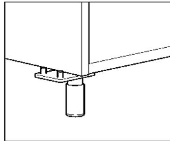
Las patas de los muebles que conectan dos muebles pueden usarse para sostener ambos mientras los estás instalando. Recuerda usar el anillo de separación incluido con las patas.
