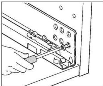
Fija las guías para cajón, comenzando con los cajones exteriores. Las guías para cajones exteriores deben estar fijadas a la fila de agujeros externos de tu mueble.
