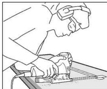
Usa una sierra caladora para cortar el espacio para tu lavaplatos. Es útil taladrar un agujero en las esquinas interiores del contorno antes de cortar, para que puedas hacer un corte más preciso.
