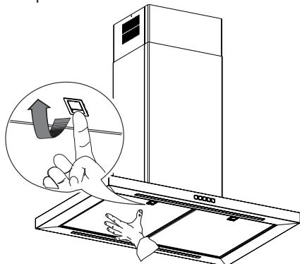
**Remplacement des ampoules**
