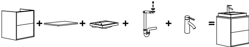
Pour créer un meuble-lavabo avec un lavabo semi-encasté ou une vasque, vous avez besoin d'un meuble pour lavabo, d'un comptoir, d'un lavabo, d'un siphon et d'un robinet.
