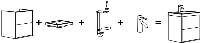
Pour créer un meuble-lavabo à lavabo intégré, vous avez besoin d'un meuble pour lavabo, d'un lavabo, d'un siphon et d'un robinet.
