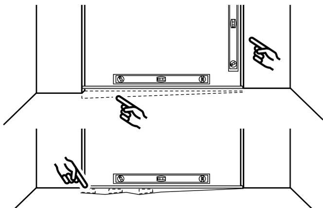
Les surfaces inégales ou inclinées doivent être ajustées avant l'installation des portes. Les portes coulissantes SKYTТА n'ont pas besoin d'être ajustées si l'irrégularité du sol ne dépasse pas 2 mm ( $\frac{1}{8}$  po) par 1 m ( $39\frac{3}{8}$  po), ou si l'irrégularité du mur ne dépasse pas 3 mm ( $\frac{1}{8}$  po) par 1 m ( $39\frac{3}{8}$  po).
