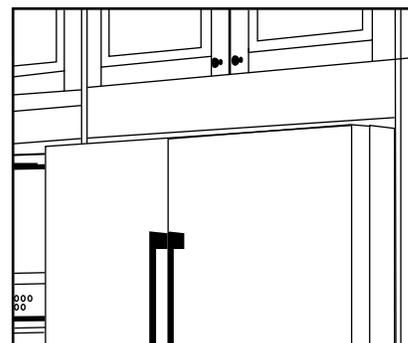
**Panneaux-décor:** à couper à partir d'un panneau de finition d'une épaisseur de 1/2 po ou d'un panneau latéral de 3/8 po. Pour créer un panneau-décor au-dessus du réfrigérateur, utiliser une façade de tiroir de 5 po de largeur.
