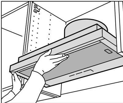
Installez maintenant la hotte. La plupart des hottes vendues chez IKEA présentent deux options: d'abord la version à extraction, la plus commune, qui se raccorde à un conduit d'évacuation et l'autre, qui fonctionne avec un filtre à charbon pour recirculation de l'air. Chaque mode d'installation est décrit dans la notice fournie à l'achat.
