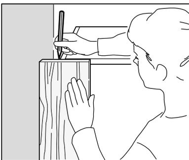
Placez maintenant le bord nouvellement taillé du cache-décor contre le mur. Les profils devraient correspondre parfaitement. Marquez d'un trait le bord du caisson au bas et au haut du cache-décor. Tracez une ligne droite entre ces deux points, puis coupez.
