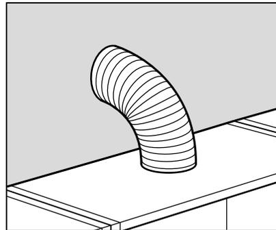
Percez le trou dans le panneau arrière ou supérieur du caisson. Consultez la notice d'assemblage fournie par le fabricant. Pour assurer la sécurité et le fonctionnement efficace, veuillez respecter à la lettre les indications concernant les mesures.
