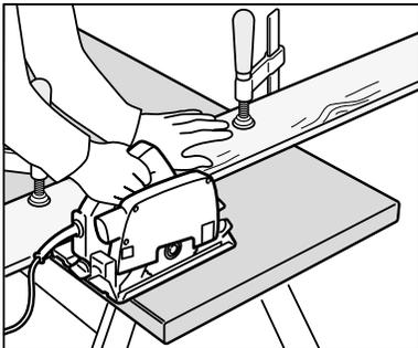
À l'aide de la scie circulaire, taillez le comptoir en coupant le long d'une latte-guide tenue par deux serre-joints. Il est recommandé de poser le comptoir sur deux chevalets pour exécuter cette tâche. Conseil: pour éviter les éclats sur le rebord du comptoir, demandez à quelqu'un de tenir la pièce qui sera coupée.
