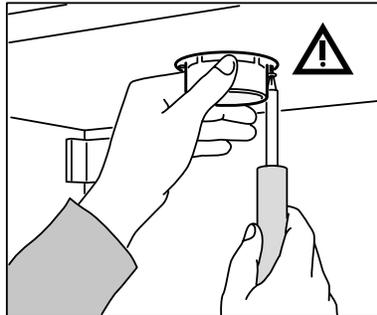
Installez vos luminaires et électroménagers. Si vous percez des trous, placez un bloc de bois du côté opposé pour bloquer le foret lorsqu'il perce la surface. Ainsi, on évite les éclats de bois.
