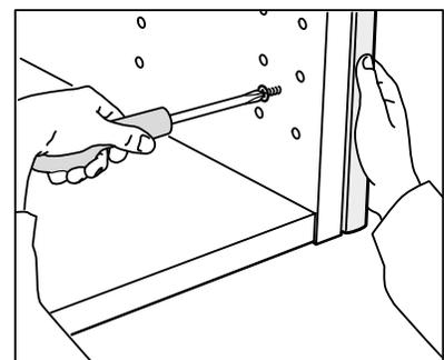
Si vous installez une armoire haute, n'oubliez pas de couvrir la paroi latérale d'un panneau de finition avant d'installer le caisson suivant.
