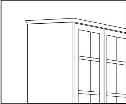
**Moules:** à utiliser pour créer corniches et bandeaux cache-lumière. Il peut être nécessaire de couper la moulure, coupe droite ou à angle, pour qu'elle convienne parfaitement à votre aménagement.
