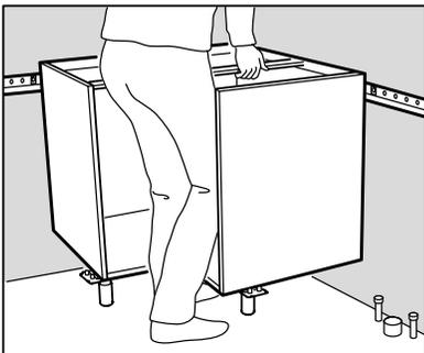
Fixez les caissons inférieurs en commençant par le caisson d'angle. Posez les autres caissons de la même manière. Si vous installez un aménagement pivotant dans le caisson d'angle, c'est le bon moment.
