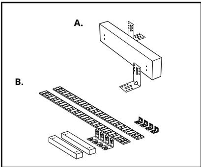
**SEKTION:** A. console de soutien servant à fixer l'îlot de cuisine au sol. B. Le nécessaire d'assemblage pour îlot de cuisine permet d'assembler des armoires dos à dos en un tournemain ou de fixer un panneau de finition à l'arrière d'un îlot ou d'une péninsule.
