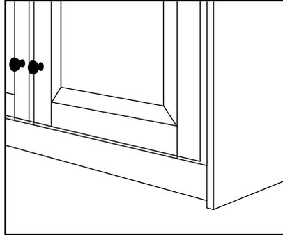
**Panneaux de finition:** épaisseur de ½ po. Couvrent les surfaces latérales exposées à l'extrémité des rangées d'armoires inférieures, murales et hautes. Procurent la même finition que les portes et façades de tiroir. Il peut être nécessaire de couper le panneau pour qu'il convienne parfaitement à votre aménagement.
