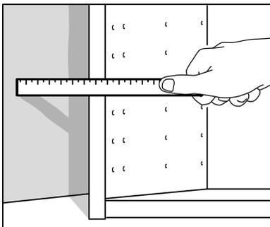
À l'aide d'un niveau, vérifiez que le mur est bien plat et égal partout. Si tout est bien droit, mesurez la distance entre le mur et l'armoire. Indiquez cette mesure aux deux extrémités du cache-décor.
