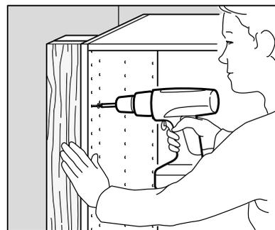
Pour vous assurer que le cache-décor tienne bien en place, vissez d'abord une baguette de soutien au mur. Percez des trous dans le caisson pour toutes les vis devant servir à fixer le cache-décor au caisson. Quand tous vos cache-décor sont vissés, calfeutrez leur contour avec de la silicone pour les rendre parfaitement étanches. Veillez à ne pas utiliser de vis là où les charnières ou les étagères seront placées.
