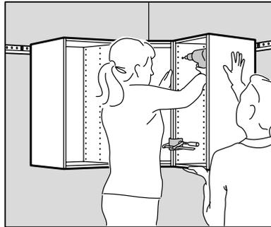
Posez le caisson d'angle en premier et fixez-le solidement en serrant les vis. Posez les autres caissons et joignez-les à l'aide des vis incluses. Ne serrez à fond que lorsque les caissons inférieurs seront posés et que vous pourrez vérifier l'aplomb de l'alignement.
