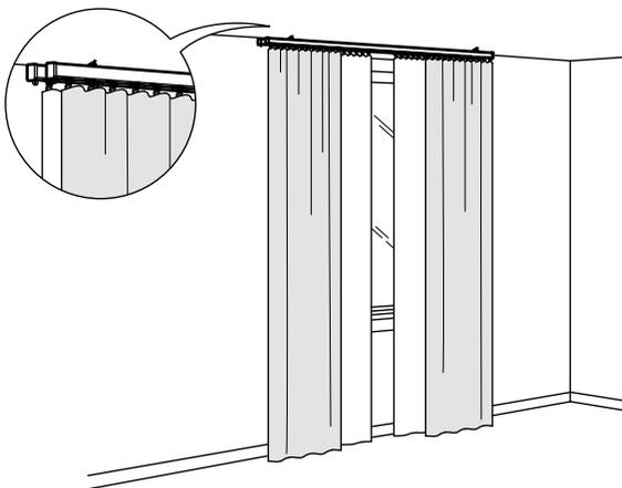
Deux tringles-rails simples VIDGA de 140 cm (55 po) fixés au plafond avec un support de plafond VIDGA pour 2 rails. Les rideaux sont fixés à l'aide de galets pour ruban froncéur VIDGA.
