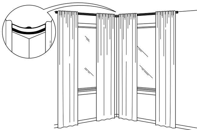
Deux tringles-rails simples VIDGA de 140 cm (55 po) fixés au plafond. Les rails se joignent au coin intérieur à l'aide d'un rail d'angle simple. Cela vous permet de tirer les rideaux vers l'intérieur du coin.
