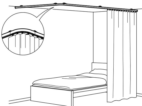
Trois tringles-rails simples VIDGA de 140 cm (55 po) fixés au plafond autour du lit. Les rails se joignent au coin extérieur à l'aide d'un rail d'angle simple. Cela vous permet de tirer les rideaux vers l'extérieur du coin.
