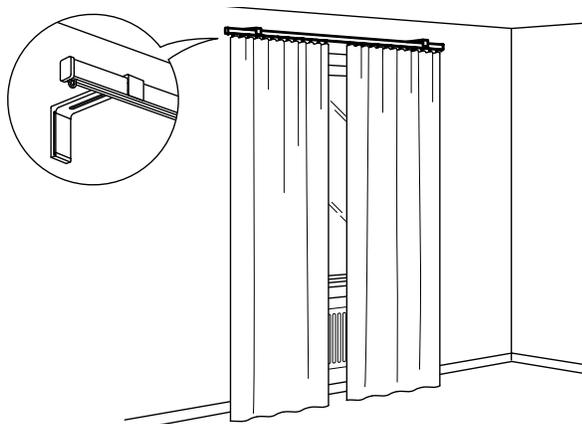
Vous pouvez mettre un rail simple ou un rail triple sur la fixation de 6 cm (2¼ po).
