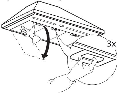
**Substituição das lâmpadas**
