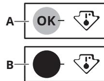
Voor het op de juiste manier bewaren van het voedsel is de koelkast uitgerust met het temperatuurlampje. Het symbool aan de zijwand van het apparaat duidt de koudste zone in de koelkast aan.
