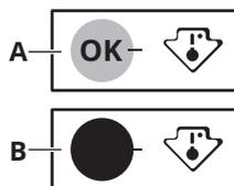
Για τη σωστή αποθήκευση των τροφίμων, το ψυγείο είναι εφοδιασμένο με ένδειξη θερμοκρασίας. Το σύμβολο στο πλαϊνό τοίχωμα της συσκευής υποδεικνύει την ψυχρότερη περιοχή του ψυγείου.
