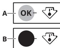
O frigorífico está equipado com um indicador de temperatura para ajudar a garantir o correto armazenamento dos alimentos. O símbolo na parede lateral do aparelho indica a área mais fria do frigorífico.
