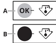
Für die richtige Lagerung von Lebensmitteln ist der Kühlschrank mit der Temperaturanzeige ausgestattet. Das Symbol an der Seitenwand des Geräts zeigt den kältesten Bereich im Kühlschrank an.
