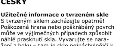
**Užitečné informace o tvrzeném skle** S tvrzeným sklem zacházejte opatrně! Poškozená hrana nebo poškrábáný povrch může ve výjimečných případech způsobit náhlé prasknutí skla. Vyvarujte se naražení z boku – tam je sklo nejnáchylnější k rozbití. Při montáži sklo opřete o karton, deku nebo jiný měkký povrch. Sklo nikdy nepokládejte přímo na tvrdý povrch – mohlo by dojít k jeho poškození a pozdějšímu rozspání.
