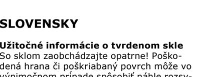
**Užitočné informácie o tvrdenom skle** So sklom zaobchádzajte opatrne! Poškodená hrana či poškrábaný povrch môže vo výnimočnom prípade spôsobiť náhle rozsypanie skla. Vyhybajte sa bočným nárazom - tam je sklo najcitlivejšie.Počas montáže položte sklo na deku, škatuľu alebo iný mäkký povrch, nikdy však priamo o tvrdý povrch. Môže to poškodiť sklo, čo neskôr spôsobí, že sklo neskôr praskne.
