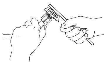
3. A questo punto, svitare manualmente il tubo di carico sul lato posteriore della lavatrice. Usando una pinza, estrarre il filtro a rete dalla valvola sul retro della lavatrice e pulirlo.
