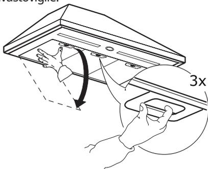
**Sostituzione delle lampade**
