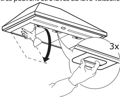
**Remplacement des ampoules**
