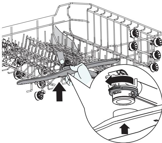
Pour fixer le bras gicleur inférieur au bas de l'appareil, insérez le bras gicleur en place.
