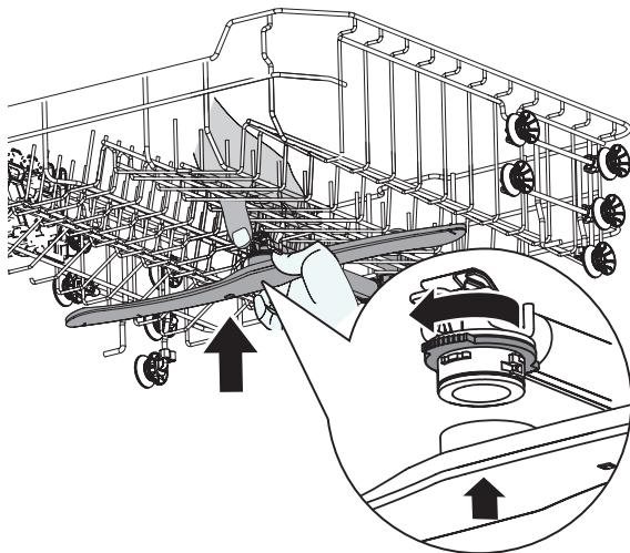
Um den unteren Sprüharm an der Unterseite des Geräts zu befestigen, setzen Sie ihn einfach ein.
