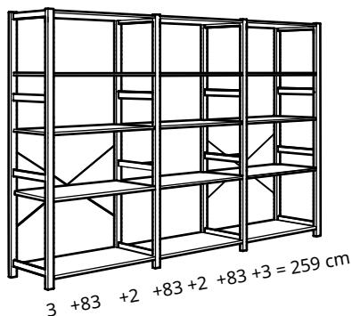
ein Seitenteil, das an die bereits vorhandene Aufbewahrungslösung mit Einlegeböden, Schränken, Schubladenelementen oder anderem Zubehör montiert wird. **Aus Stabilitätsgründen** sollte jede 2. Sektion mit einem Stützkreuz versehen werden.
