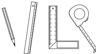
**01** Lege die benötigten Werkzeuge zum Ausmessen bereit. Rollmaß/Meterstab, Winkel.
