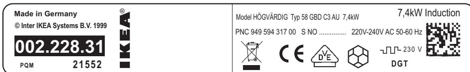
Na výše uvedené grafice vidíte výrobní štítek spotřebiče (bez sériového čísla, které se přiděluje průběžně při výrobě), který je umístěný na jeho spodní části.
