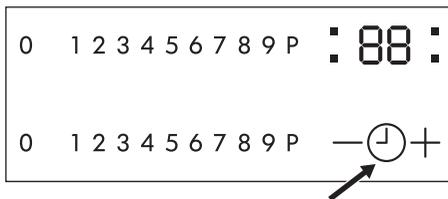
Πατήστε την ένδειξη **+** ή **-** του χρονοδιακόπτη, για να ρυθμίσετε την ώρα από **00** έως **99** λεπτά. Όταν η λυχνία ελέγχου αναβοσβήνει πιο αργά, εκτελείται αντίστροφη μέτρηση. Ρυθμίστε τη σκάλα μαγειρέματος.
