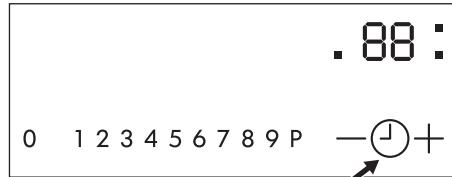
Toque los símbolos + o – del temporizador para programar la hora entre 00 y 99 minutos. Cuando la luz del piloto de control parpadea más lentamente, el tiempo se reduce. Ajuste el nivel de cocción.
