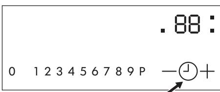
Πατήστε την ένδειξη + ή - του χρονοδιακόπτη, για να ρυθμίσετε την ώρα από 00 έως 99 λεπτά. Όταν η λυχνία ελέγχου αναβοσβήνει πιο αργά, εκτελείται αντίστροφη μέτρηση. Ρυθμίστε τη σκάλα μαγειρέματος.
