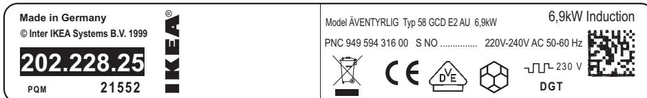
De tekening hierboven stelt het typeplaatje van het apparaat voor (zonder serienummer, dat is dynamisch tijdens het productieproces gegenereerd) en het typeplaatje bevindt zich onder de oppervlakte van de behuizing.
