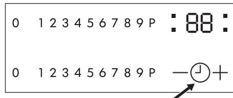
Toque los símbolos + o - del temporizador para programar la hora entre 00 y 99 minutos. Cuando la luz del piloto de control parpadea más lentamente, el tiempo se reduce. Ajuste el nivel de cocción.
